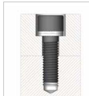
Tornillo cilíndrico asegurado en un agujero ciego
